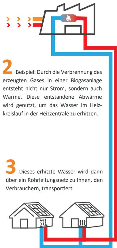
**2** Beispiel: Durch die Verbrennung des erzeugten Gases in einer Biogasanlage entsteht nicht nur Strom, sondern auch Wärme. Diese entstandene Abwärme wird genutzt, um das Wasser im Heizkreislauf in der Heizzentrale zu erhitzen.
